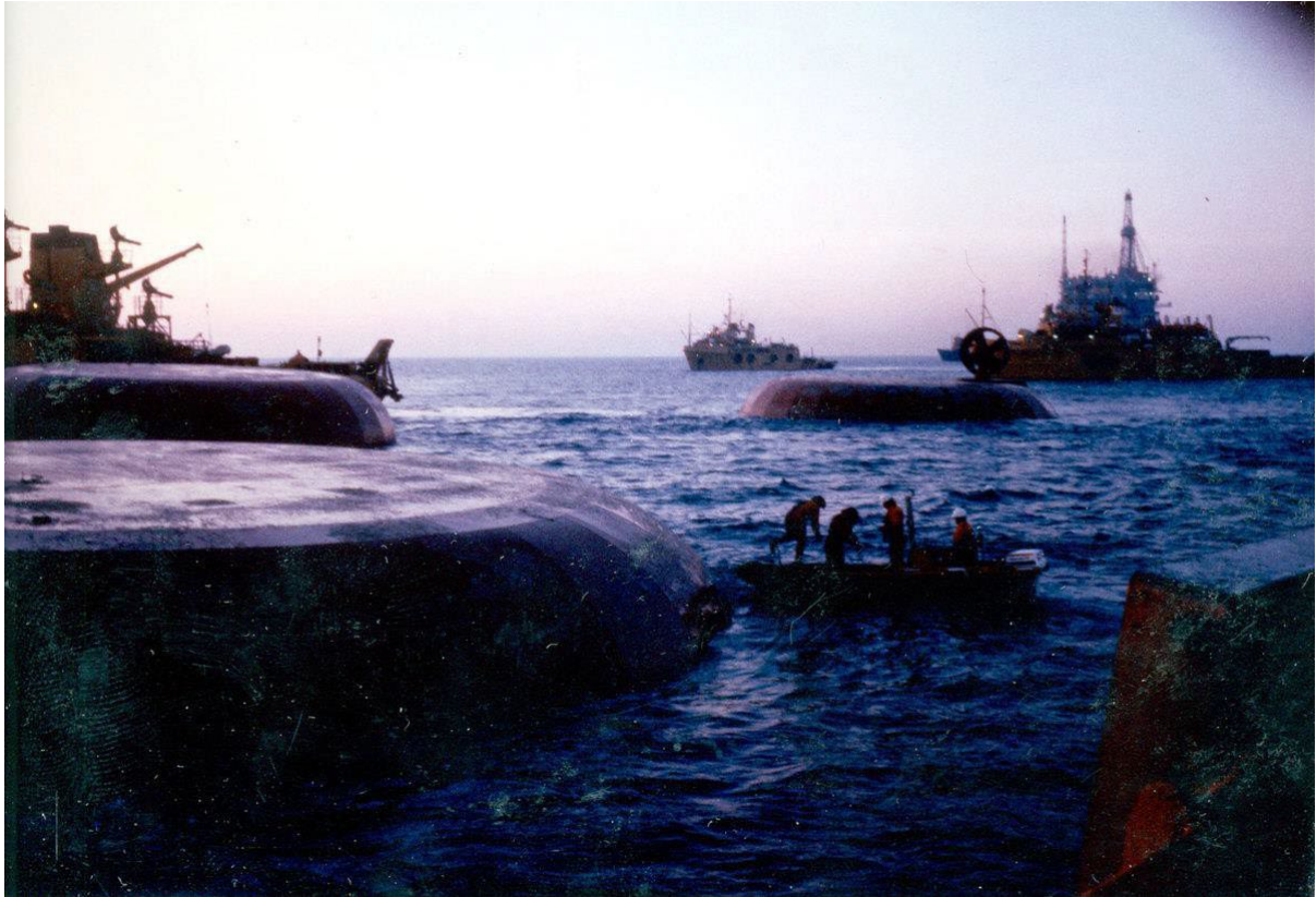
Bilde 2. På bilde er tre av fire pongtonger synlige. Mennene i båten klargjør antagelig innfesting av trosser for å taue Alexander L. Kielland fra Ekofisk og inn til land. Fartøyet i venstre billedkant er Seaway Falcon. Fartøyet i høyre billedkant er Wildrake. Foto: Torger Berge/Norsk oljemuseum. Gjengitt med tillatelse.
