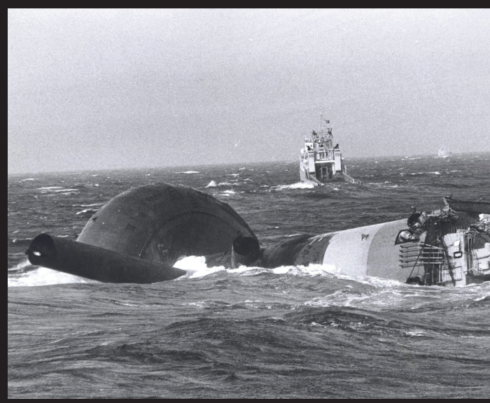
ETTER ULYKKEN: Her flyter plattformbenet som løsnest slik at Alexander Kielland havarerte. FOTO: SCANPIX
